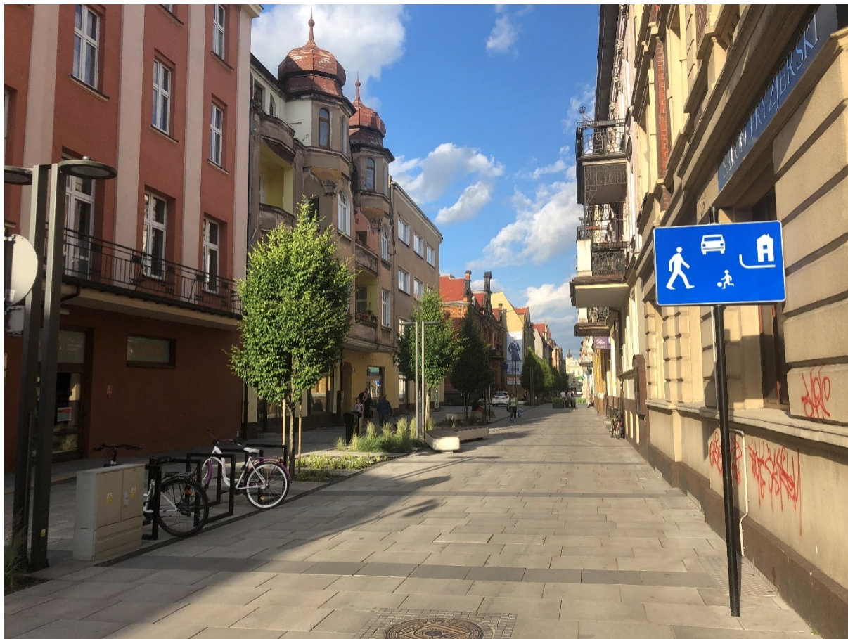
Zdjęcie 7. Ulica Kolejowa w Ostrowie Wielkopolskim w formie strefy zamieszkania (woonerf).
