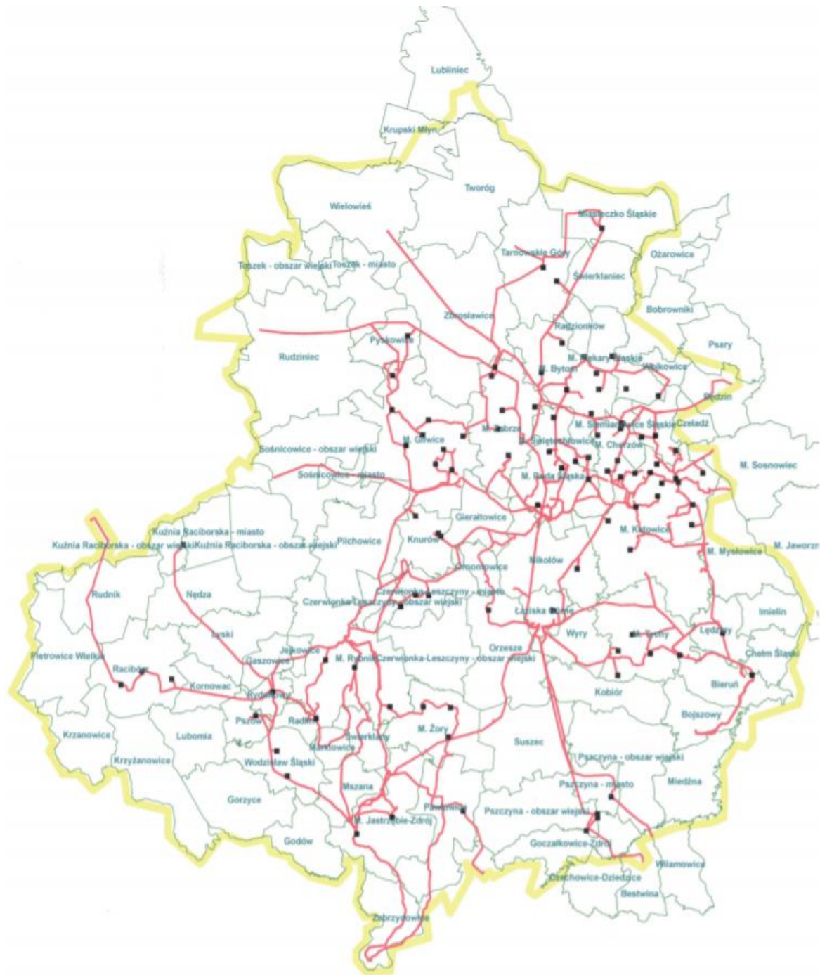
Rysunek 6 Rozmieszczenie linii i stacji elektroenergetycznych 110 kV na obszarze działania Vattenfall Distribution Poland - przebieg sieci WN
