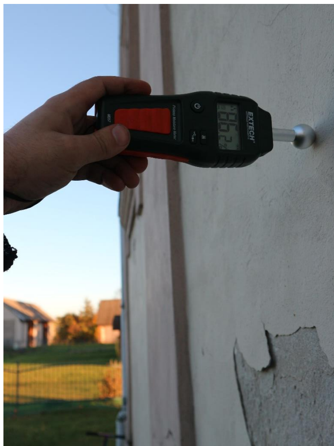
Fot. 17 Zawilgocenia powierzchniowe muru/tynku prezbiterium od strony północnej – tynk ok. 2m od terenu – ok. 86%. Wyniki świadczą o znacznym zawilgoceniu strukturalnym muru
