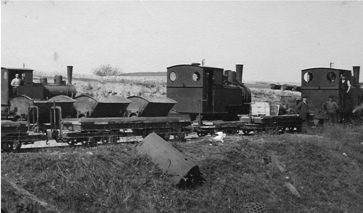
Przewóz próżnych wywrotek-wozów i platform lokomotywami do miejsc załadowania produktami z granitu.
