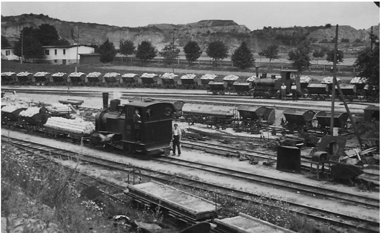
Przewóz lokomotywami kostki w wywrotkach i krawężników drogowych oraz licówki z granitu na platformach.
