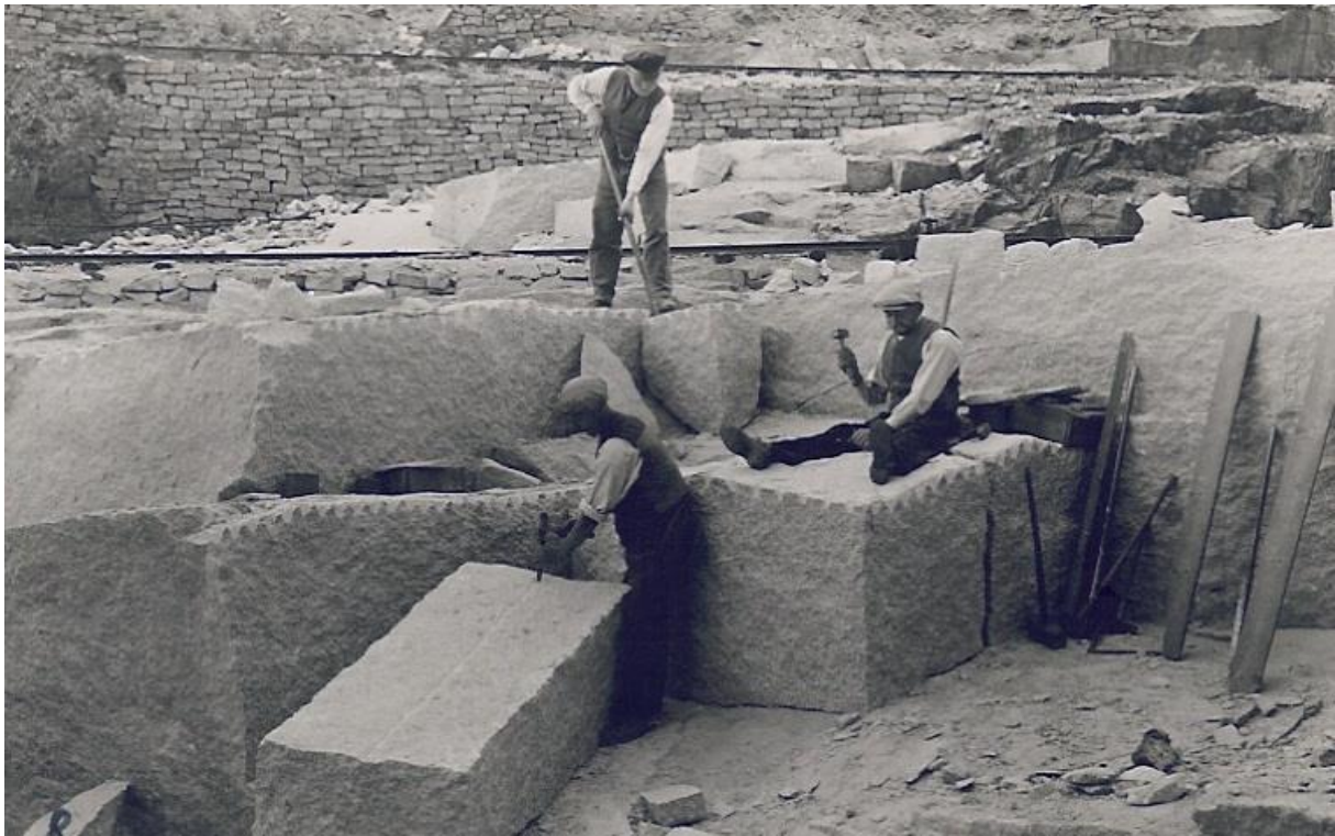
Rozpoczęcie drążenia gniazd klinowych wzdłuż bruzdy podziału bloku granitu, za pomocą szpiczaka i młotka ręcznego.
