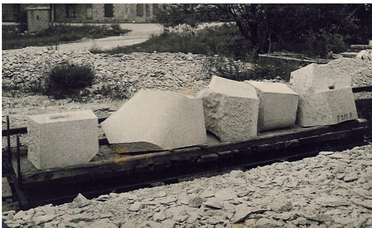
Elementy licówki budowlanej z granitu.
