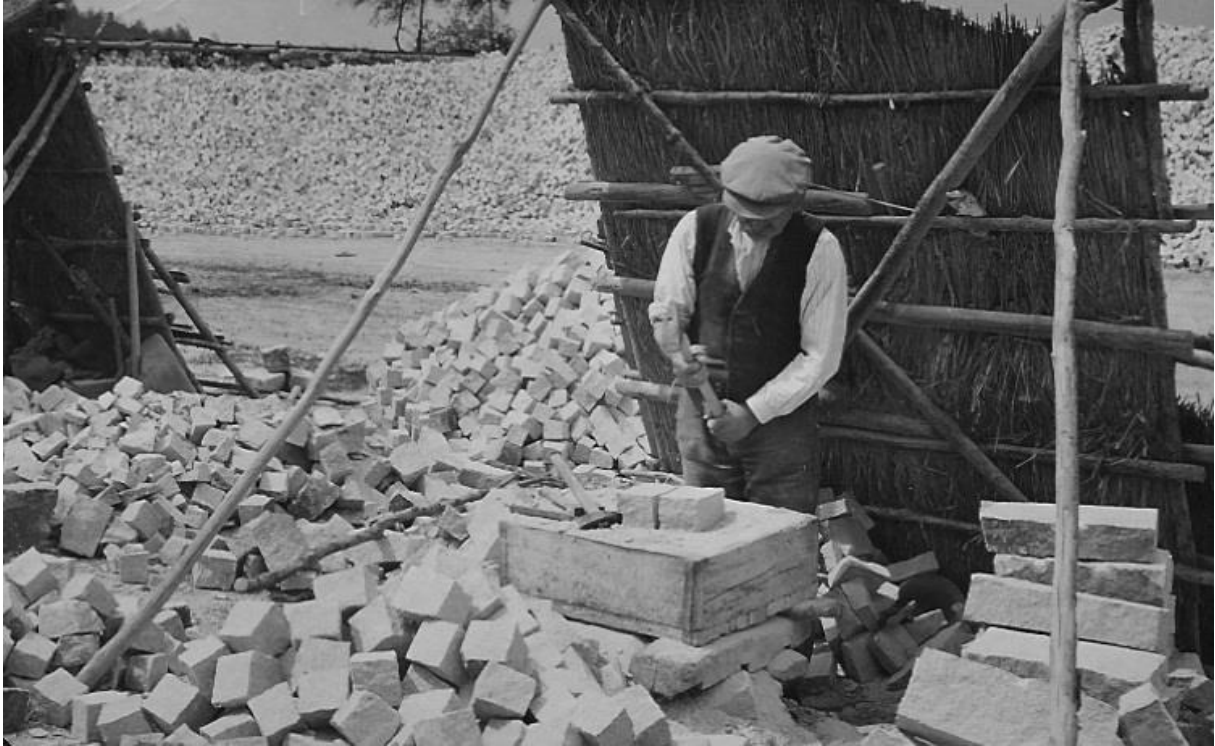
Popukanie dwóch przeciwległych (bądź jednej przeciwległej ścianki) na wysokość nacięć (lub nacięcia) do chwili rozłupania ćwierćformaka na 2 kostki
