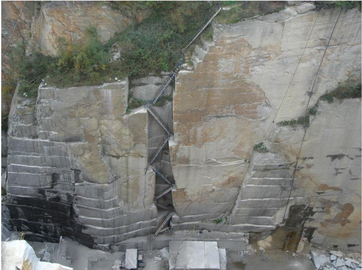
Klatka schodowa częściowo wypalona palnikiem wrębowym, kamieniołom „Kwarc” w Kostrzy. Fot. T. Praszkie.
