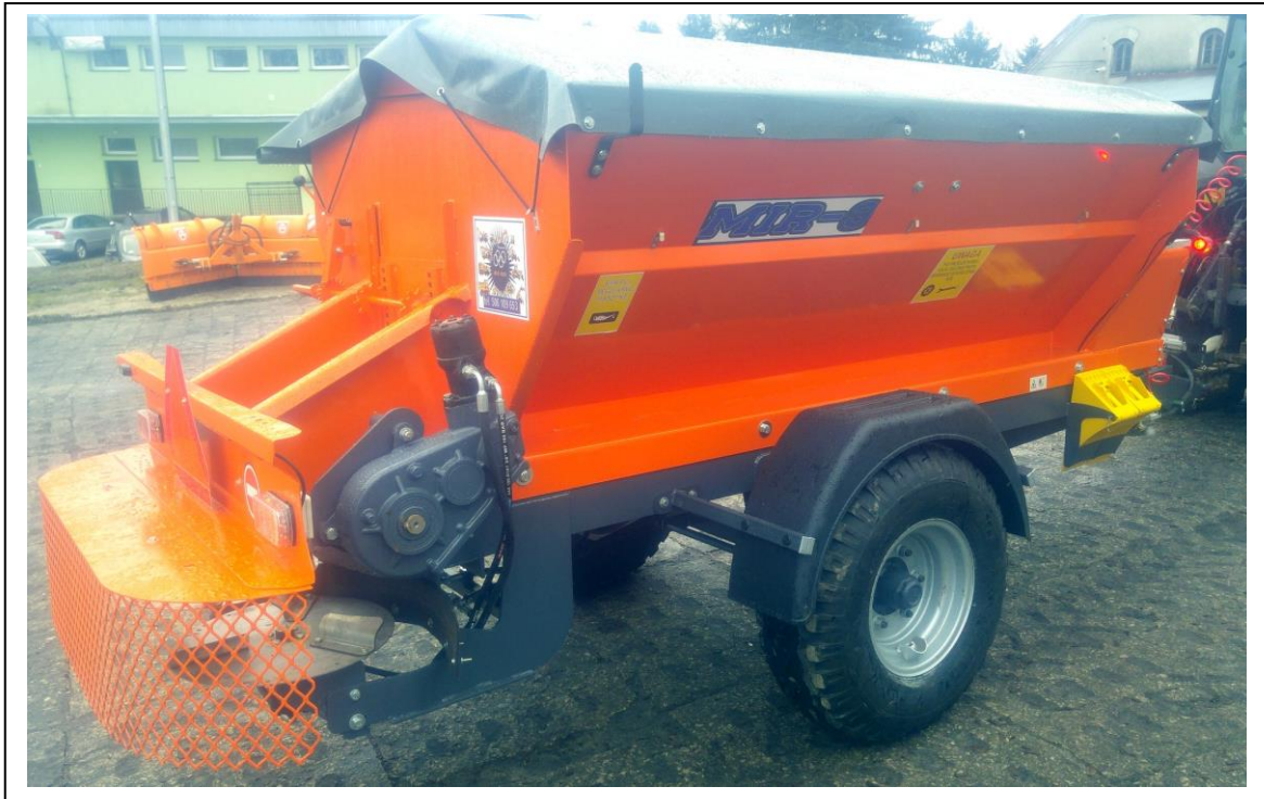
Fot. 26. Posypywarka do piachu i soli MIR-3 przeznaczona do prac związanych z utrzymaniem infrastruktury drogowej.
