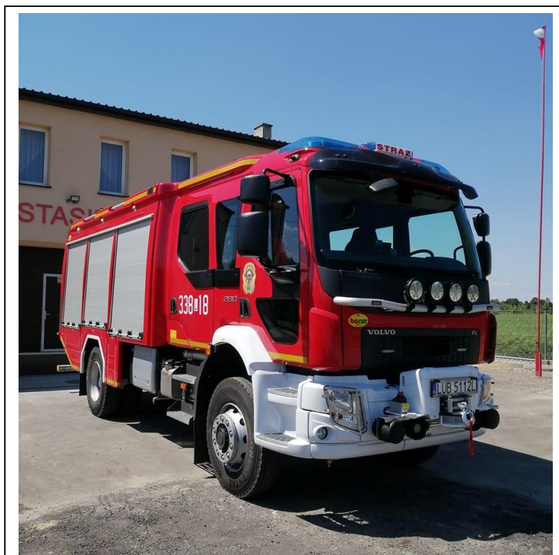
Fot. 60. Nowy średni pojazd ratowniczo-gaśniczy Volvo FLD3C FL GBA-Rt 3,2/16 - OSP Stasin.
