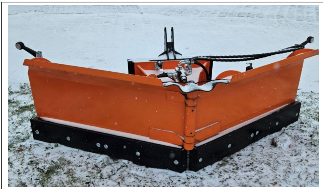
Fot. 27. Pług hydrauliczny do odśnieżania dróg i chodników na terenie gminy.
